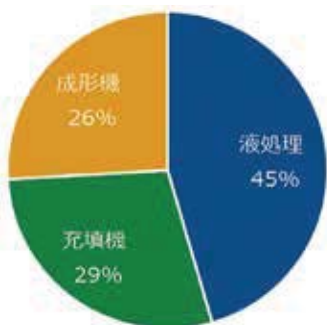
第1図 PET ボトル無菌充填設備 CO 2 排出量内訳(調合、包装工程含まず)
